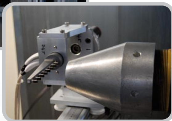
🔗 Etalonnage d'un peigne de mesures pour performances moteur / Calibration for a probes used for engine performance determination
