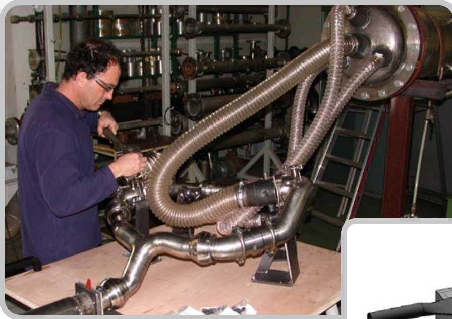
Caracterisation en temperature et debit de materiaux d'isolation thermique montes sur nacelle / Temperature and flow characterization of thermal insulation material mounted on turbofan
